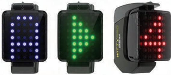
Le **WittySem Pro** est un système lumineux polyvalent permettant de créer des exercices d'agilité avec prise d'informations ou des tests cognitifs. Grâce à son détecteur placé sur la face avant et sa matrice de leds (7x5) affichant des chiffres, lettres, symboles ou flèches de différentes couleurs, vous pourrez créer des séances spécifiques à vos besoins.
