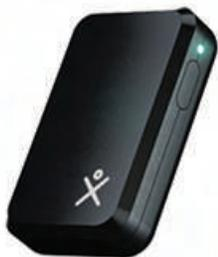
Le **Tag gpexe i** est le positionneur placé sur l'athlète. Le système possède une précision de positionnement inférieure à 10 cm. Grâce à une technique de mesure du temps de transit radio, le Tag calcule le déplacement, la vitesse, les accélérations à 20 Hz. Il intègre également un récepteur de fréquence cardiaque et une centrale inertielle pour capturer les chocs, les sauts, ou tout autre événement.
